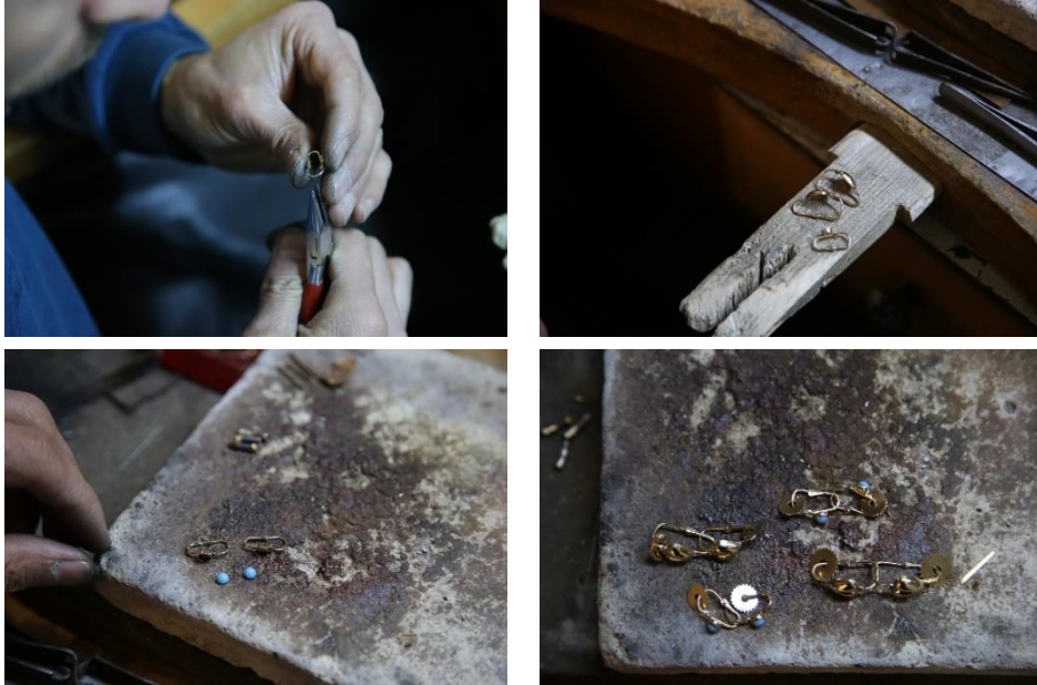
Şekil 3. Çengellerin oluşturulması, taş ve perperenin yerleştirilmesi
