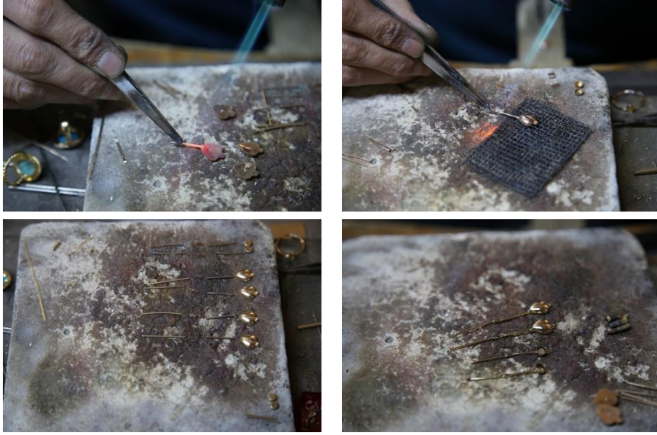
Şekil 2. Kalbin, taş yuvasının ve menteşe mekanizmasını oluşturulması
