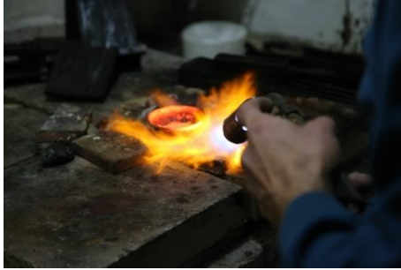
Şekil 1. Eritme, kalıba dökme, tel ve astar üretimi
