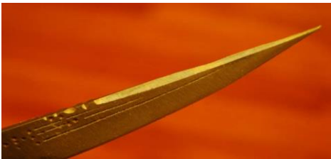
Sivri bıçak üzerinde sırtın inceltilerek süslenmesi örneği
